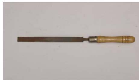
こて先磨き用ヤスリ ワイヤー状・ブラシ状は使用不可 使用時間まで預かりとする
